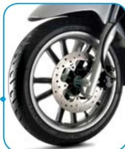
**Easy brake**, freno a disco anteriore e posteriore da Ø 260 mm
