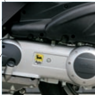
Motore 4 tempi, raffreddato a liquido.
