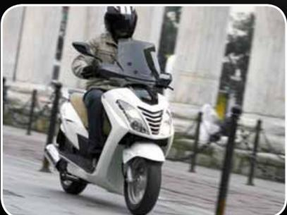
Il peso a secco è di 138 Kg, sinonimo di facilità di guida sia nel traffico urbano che extra-urbano e rende adatto il veicolo ad ogni tipologia di utenza sia maschile che femminile. Autonomia: con un serbatoio con capienza di oltre 9 litri, BLOG ha un'autonomia di oltre 300 km.
