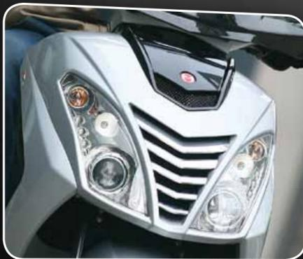
Fanali poliellissoidali ad elevata luminosità inseriti nel gruppo ottico anteriore sdoppiato, di stile automobilistico completo di indicatori di direzione e luce di posizione.
