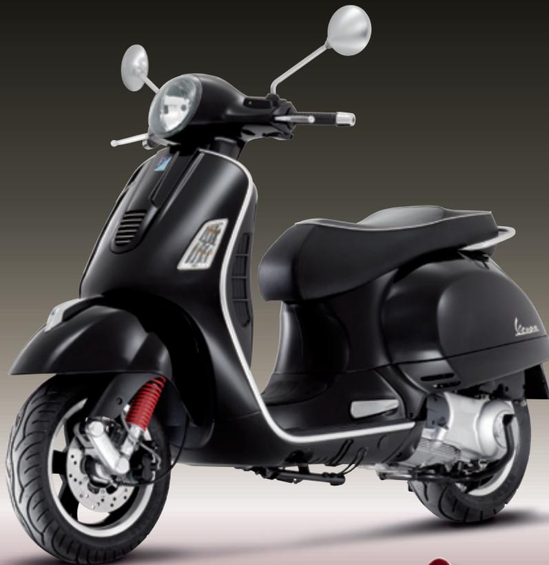
GTS300ie Superはベスパの誇るフラグシップモデル GTS250ie より更にスポーティエレガンスを踏襲したスポーディクラシックモデルです。搭載する新設計の300ccクォーサー4サイクル4バルブSOHC水冷インジェクションエンジンは、250ccエンジンよりも低回転にてハイレベルのトルクとパワーが得られ、よりスポーティなライディングが楽しめます。
