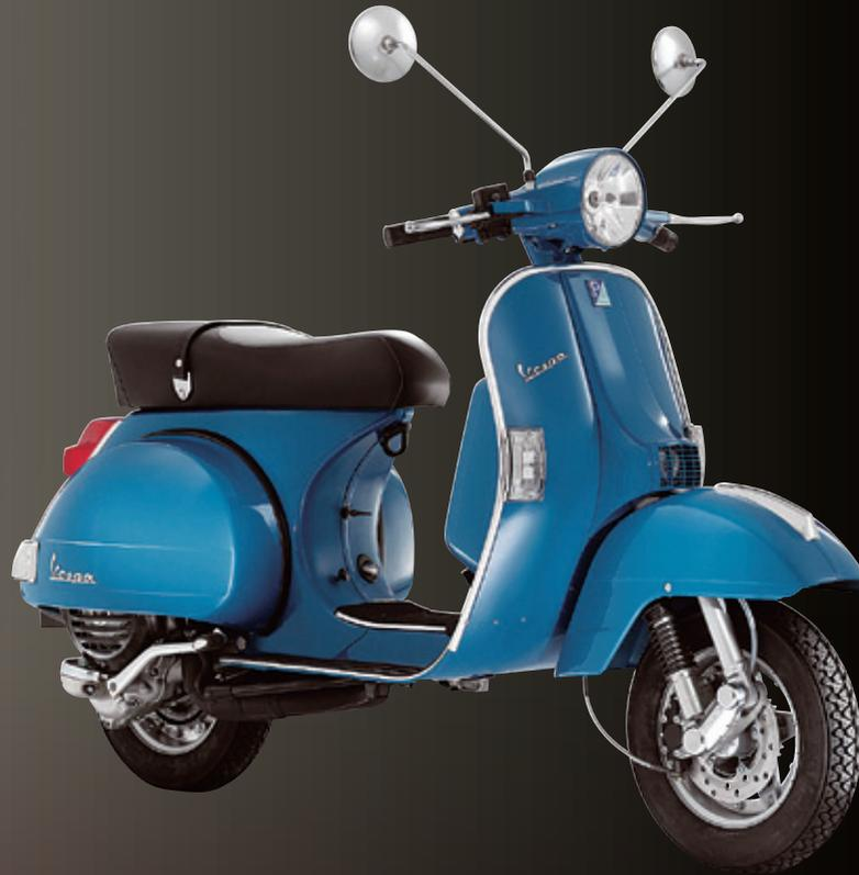
ベスパのクラシックモデル PXシリーズが 2011年に復活します。しかもエミッションEuro3をクリアしての発売です。PX Euro3モデルは 4スピードマニュアルギアを備え、伝統のクラシックデザインが現代に生きる堂々のモデルです。PX Euro3モデルは、ディスクブレーキをフロントに採用の他、インスツルメント、ハロゲンヘッドランプ(コンプレックス レフレクター採用)、シート等 オリジナルデザインを踏襲します。勿論ベスパのみが採用するスチールモノコックボディに、エンジン出力をチェーンやジョイントを介せずダイレクトに後輪をドライブするダイレクトトランスミッション、ベスパ独特のパワーユニットです。
