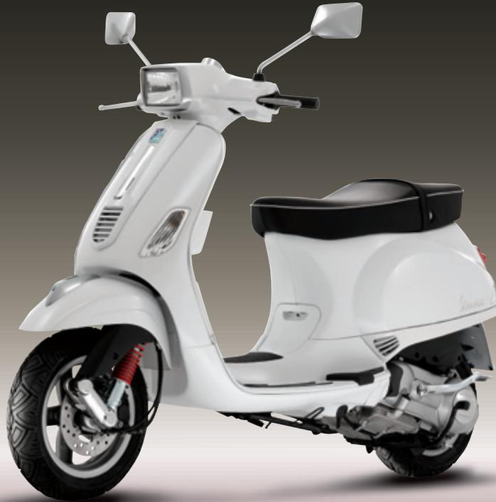
VESPA S モデルは ベスピーノ デザインコンセプトにもとずき新しく開発されました。1970年代のかの有名な名車 VESPA 50S、VESPA Primavera、のデザインを追求したニューモデルです。角型ハロゲンヘッドランプを採用、5スポークデザインのホイールをフロントに11インチ、リアに10インチ を装着、よりスポーティな走行の安定度を追求しました。最新型のLEADER4ストローク SOHCインジェクションエンジンを搭載した S125モデルとS150モデル、HI-PER4 4ストロークエンジンを搭載したS50モデルがごさいます。
