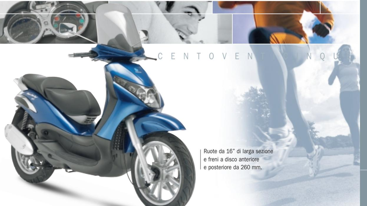
Ruote da 16" di larga sezione e freni a disco anteriore e posteriore da 260 mm.
