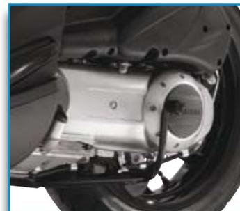
Potente motore QUASAR 300 ad iniezione elettronica
