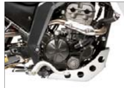
Cubreamortiguador, monoamortiguador posterior con mayor recorrido y protección de aluminio para el cárter, motor y chasis/Copri ammortizzatore, monoammortizzatore posteriore con maggiore corsa e protezione di alluminio per il carter, il motore e il telaio/Shock absorber cover, rear monoshock with longer wheel travel and aluminium protection for the crankcase, the engine and the frame.
