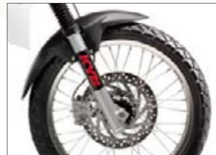
Llantas de 21" en la rueda delantera y de 17" en la trasera, neumáticos trail y horquilla de 41 mm para una mayor estabilidad y rigidez/Cerchio anteriore da 21" e posteriore da 17", pneumatici trail e forcella da 41 mm per una maggiore stabilità e rigidità/21" front and 17" rear wheel rims, trail tyres and 41 mm fork for superior stability and rigidity.
