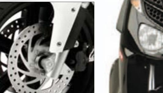
Anchos neumáticos. Sistema de frenos con disco delantero de 260 mm en la versión 125 cc - doble disco en la versión 300i - y disco trasero de 220 mm/ Pneumatici larghi. Sistema di freni con disco anteriore da 260 mm nella versione 125 cc - doppio disco nella versione 300i - e disco posteriore da 220 mm/Broad tyres. Precise and effective braking thanks to a 260 mm front disc in the 125 cc version – double disc in the 300i cc – and 220 mm rear disc.
