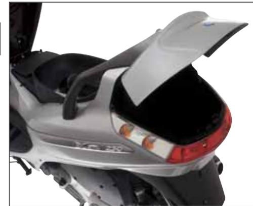
Il vano retroscudo assicura un comodo spazio per piccoli oggetti come i guanti e il telefono cellulare. Nel vano si trova una presa da 12V per la ricarica del cellulare.
