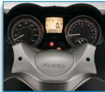
Strumentazione analogica digitale con computer di bordo e contagiri.
