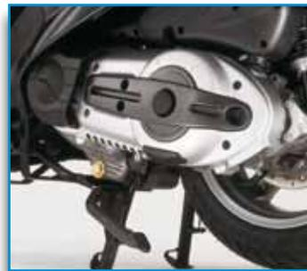
Motore MASTER 400 ad iniezione elettronica omologato Euro 3, potenza e rispetto per l'ambiente.
